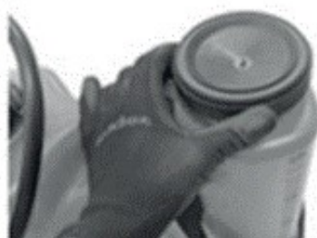
Verificação e instalação da peneira no reservatório
